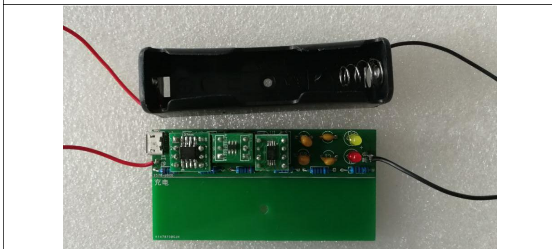
焊接电池盒和底座的电路, 并将 DW01 芯片转接电路安装到 U3、8205A 芯片转接电路安装到 U1、TP4056 芯片转接电路
