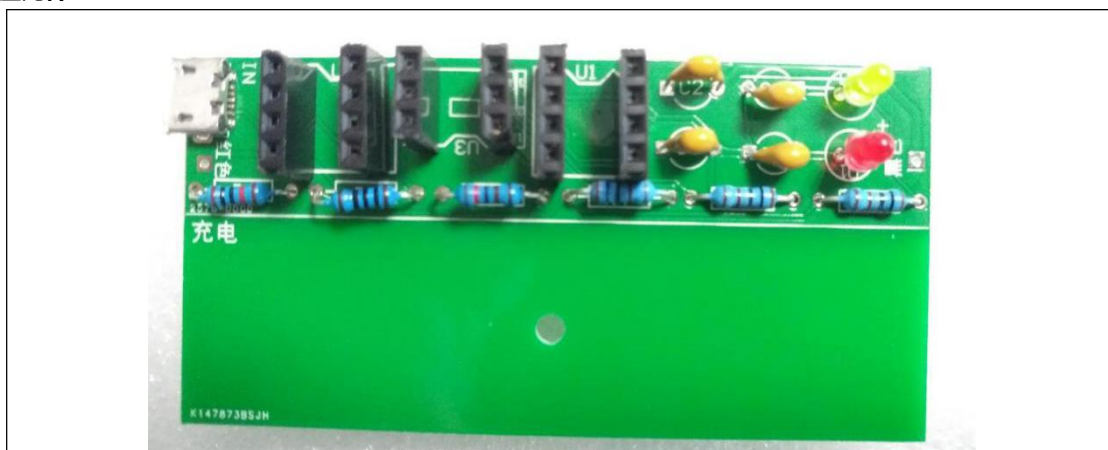
插座、电阻、电容、红色 LED、黄色 LED、USB 口焊接 (注意: 此处涉及红、黄 LED 正负极辨别, 请查看该项目下注意事项说明)
