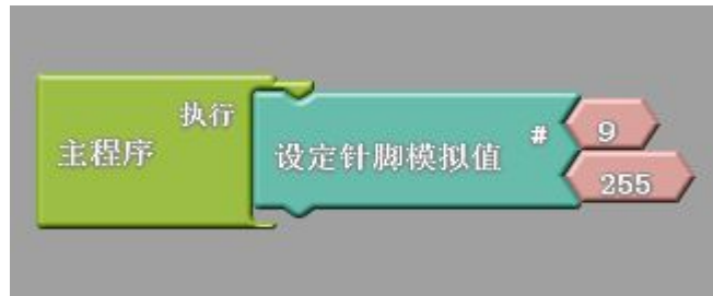
图 1.4 驱动轮转速的控制
