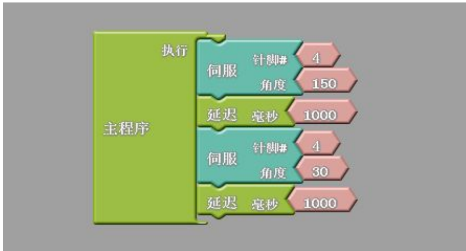
图 12.2 机械手往复运动程序的另一种写法
