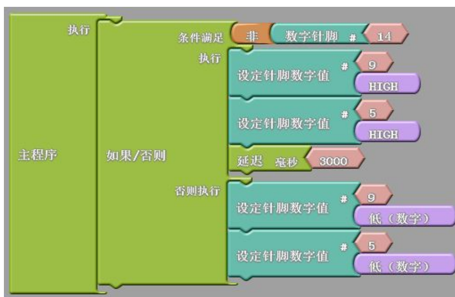
图 3.4 触碰开关启动双轮小车
