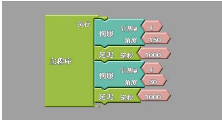
图 11.3 关节模块摆动程序的写法
