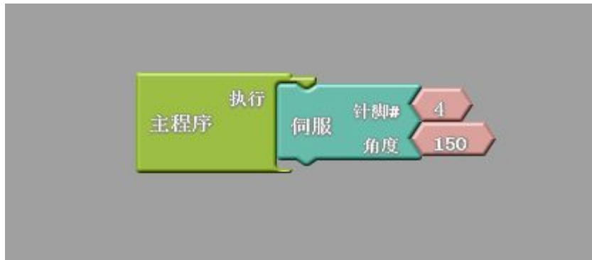
图 11.2 关节模块摆动程序的写法
